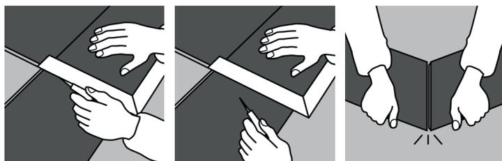
Stellen Sie sicher, dass die erste Bahn genau gerade verlegt ist und sichern den 10 mm Wandabstand mit Keilen, auch an den beiden Enden.
